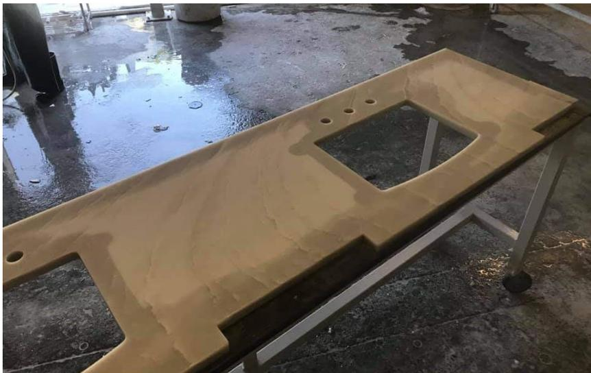
Bild 1: Kantenverfleckung durch Feuchtigkeitseintritt nach Wasserstrahlschneiden
