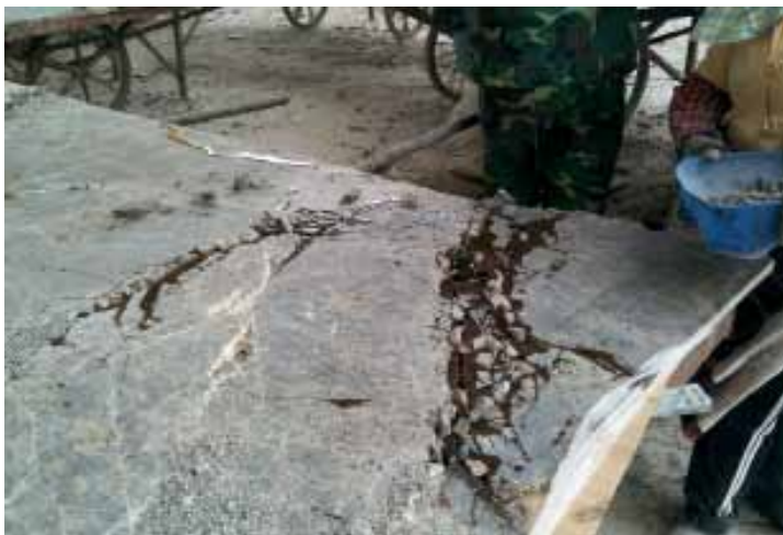
Zusammensetzung einer spanischen Emperador Brown Platte in China mittels Epoxidharz
