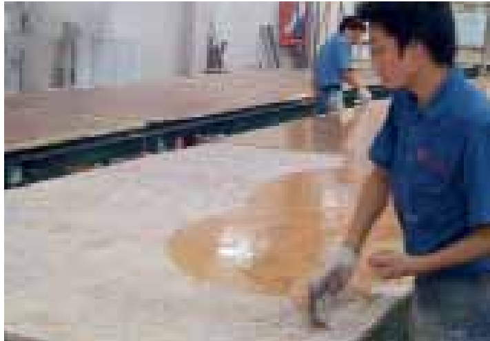
Zusammensetzung einer spanischen Emperador Brown Platte in China mittels Epoxidharz
