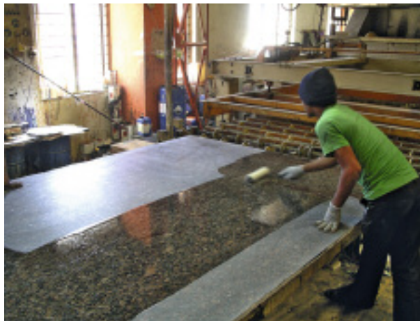
Händische Resinierung einer Unmaßplatte in einem indischen Steinmetzbetrieb. Akemi sieht sich nicht nur als Produktanbieter, sondern auch als Vermittler von Know-how.
