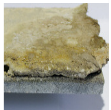
Links: Die rückseitige Beschichtung wird vor dem Verlegen auf die Plattenrückseite aufgerollt, am besten werkseitig. Mitte: Nach dem Auftrag wird die behandelte Plattenseite abgesandet und über Nacht ausgehärtet. Rechts: An dieser Platte lässt sich die gute Verbundfestigkeit zwischen dem Verlegemörtel und der beschichteten Natursteinplatte erkennen, und das, obwohl die Platte vor dem Ausstemmen über zwei Jahre der Bewitterung ausgesetzt war.
