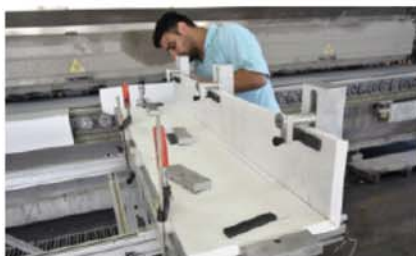
Einspannen der Platten in eine Klebevorrichtung und justieren der Platten
