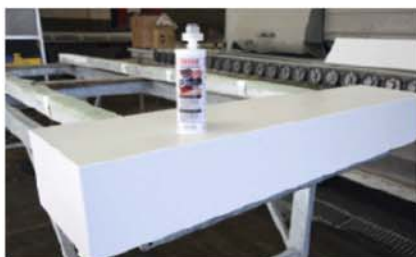
Fertige Austrittsstufe in Massivoptik, geklebt mit Akemi »Colour Bond«
