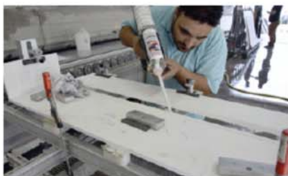
Auftragen des Klebers »Colour Bond« mittels einer pneumatischen Pistole
