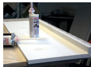
Nach ca. 20–30 Minuten bei 20°C ist die Gehrungsverklebung ausgehärtet und kann weiter bearbeitet werden (Schleifen, Bohren, Fräsen).
