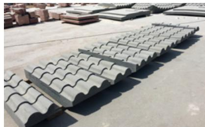
Die Dachelemente wurden teilweise vormontiert und zu transportfähigen Einheiten verklebt.
