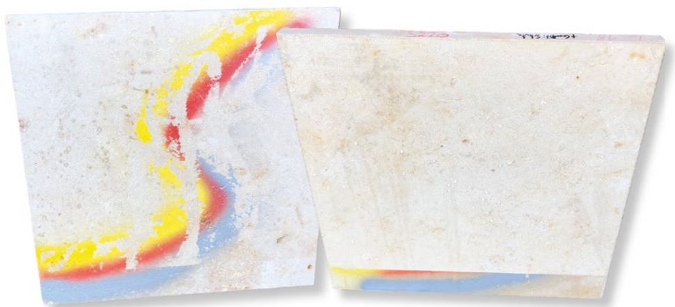
Tellergestrahlte Jura-Kalkstein-Platte nach der Reinigung mit Dampfstrahler ohne Graffiti-Schutz (links) und mit Anti-Graffiti und Graffiti-Entferner von Akemi
