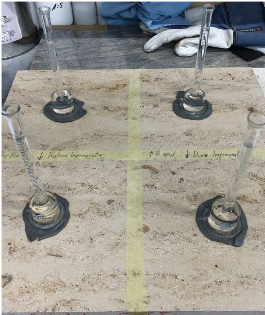
Eindringprüfung von Wasser mittels Karstensch's-Röhrchen Fotos: Akemi
