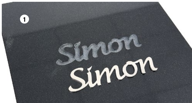
Um die Metallbuchstaben einkleben zu können, muss der Stein zunächst sandgestrahlt werden. Hierfür können individuell angepasste Sandstrahlfolien gekauft werden. Fotos: Firma
